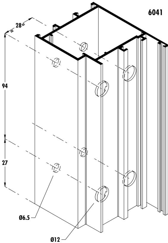
**Mecanizado para colocación
