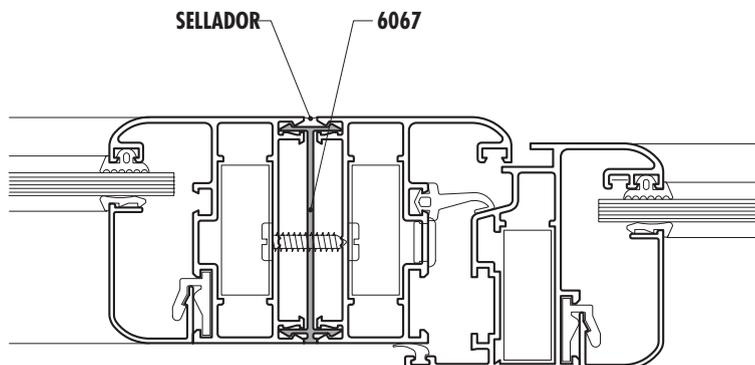
**Detalle acople corrediza de 3 guías a 60 mm.**
