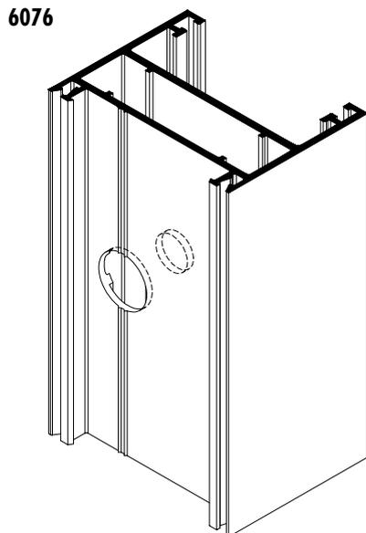
**Mecanizado para colocación
