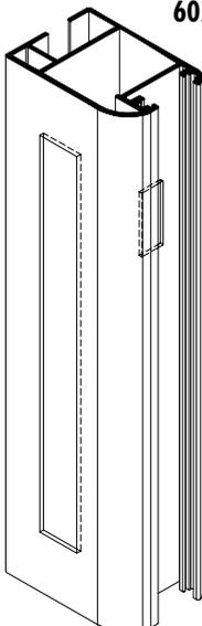
**Mecanizado jambas de marco para encastre de umbral y dintel**
