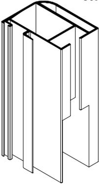
**Mecanizado parantes para pasaje de guías y agujero de armado**
